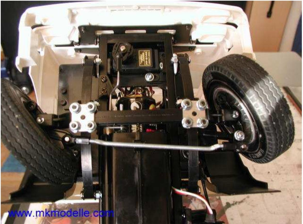
Beim Aufbau, wurden gleich schon am kompletten Fahrzeug, die passenden Kugellager und ein Truckmotor montiert.
